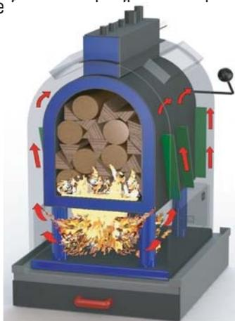
La combustion est naturellement aspirée vers le bas grâce à la conception de la chambre de combustion en dépression du fait du tirage naturel de la cheminée. La combustion se produit à la fois de façon concentrée et
